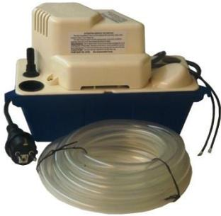
Automatisch arbeitende Hebeanlage für Kondenswasser aus Brennwertkesseln, Klimaanlage, Kühlgeräten, Luftentfeuchtern oder vergleichbaren Anlagen. Die entsprechenden Vorschriften zur Ableitung in die Kanalisation sind zu beachten. Falls erforderlich ist eine Neutralisationsanlage vorzuschalten. In trockenen Räumen (frostsicher + Lufttemperatur nicht höher als 60°C) an der Wandunterhalb des Kondensatzuführungsablaufs zu montieren.
