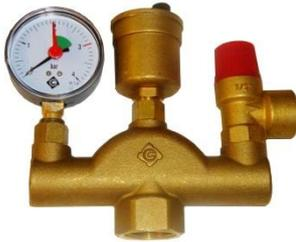
Kesselgruppe für geschlossene Heizungsanlagen nach DIN 4751 für Leistungen bis 50 KW bzw. 45.000 Kcal/h. Konsole aus massivem Messingguss. Zwangsluftführung zum automatischen Schnelllüfter mit Absperrventil. Komplett ausgerüstet mit:
